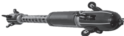
Рис. 1 ВТИП методом акустического резонанса
